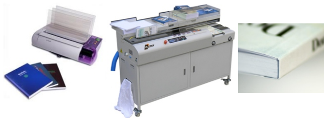
Máquina para PB semi-industrial (perfil) e para PB industrial (colagem térmica direta capa/miolo)
