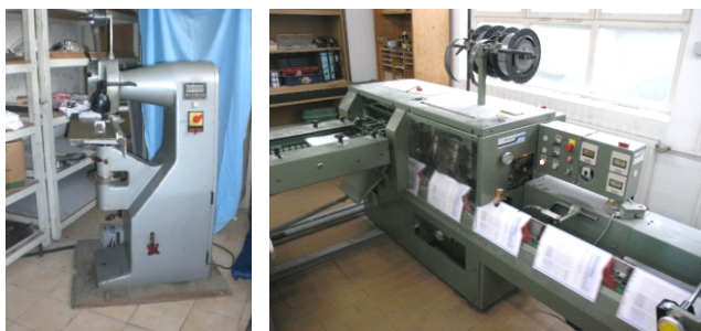
Grampeador elétrico e grampeador automático, ambos alimentados com rolos de arame (grampos).
